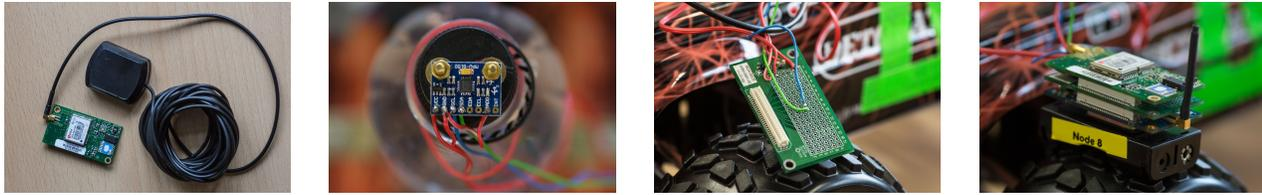
(a) GPS module (b) MPU-9150 (c) Expansion board (d) Full mote stack
